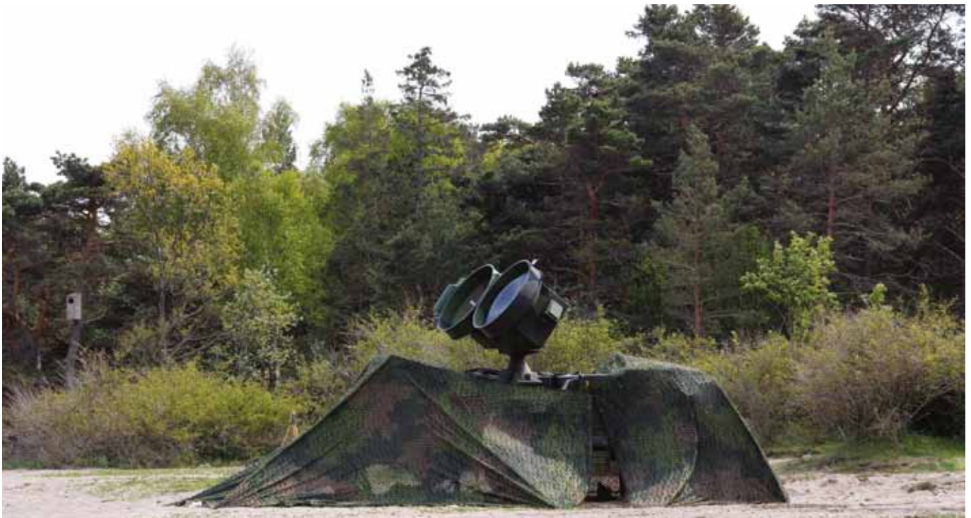
Luftvärnet spelar en avgörande roll för våra möjligheter att försvara Gotland. Bilden visar belysningsradarn PE 542 som ingår i robotsystem 97. Foto: Christian Lövgren, Försvarsmakten.
